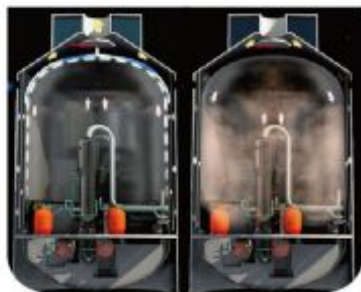
事故时顶部水箱依靠重力向堆芯安全壳内喷淋补水，保持堆芯热平衡
