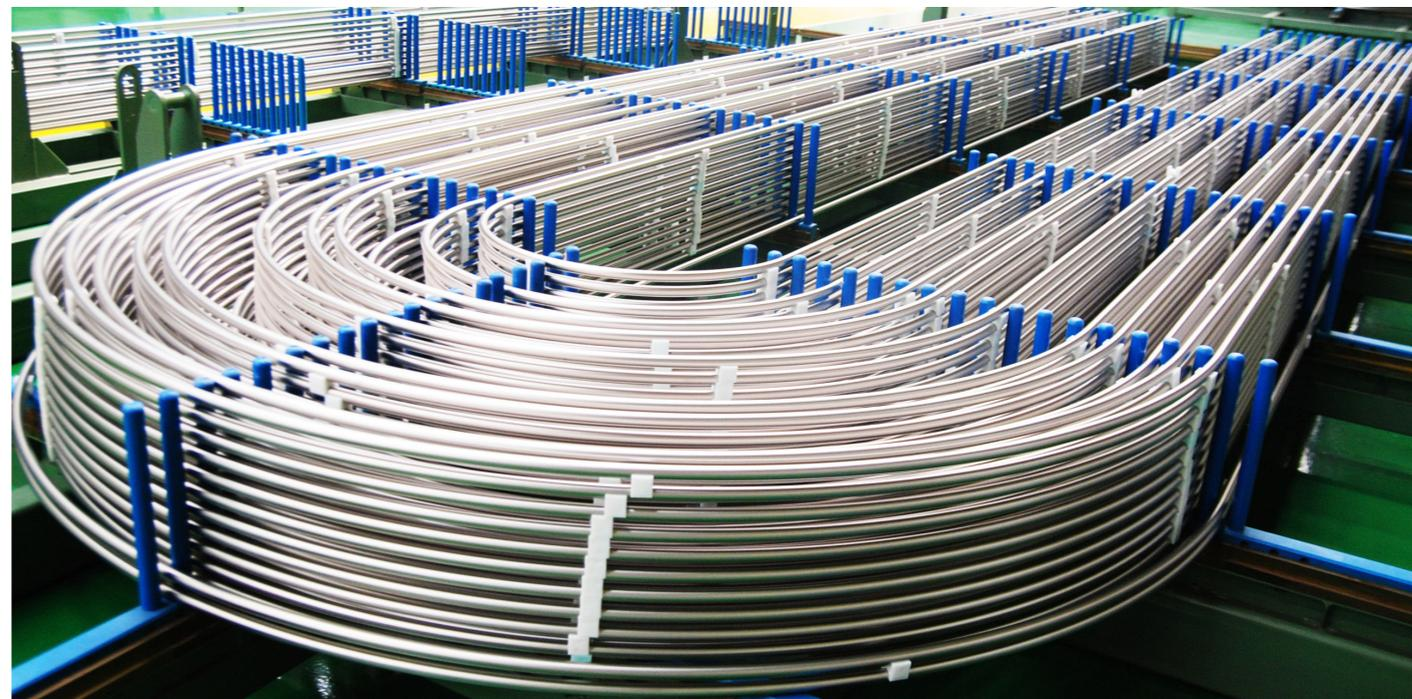
▲ U形管的质量事关蒸汽发生器乃至整座核电站的安全
