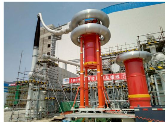
2030 三个一流 + 党建战略的关键在于实施。图为 4 月 8 日, 田湾 6 号机组 500kV GIL A 相耐压试验进行中
