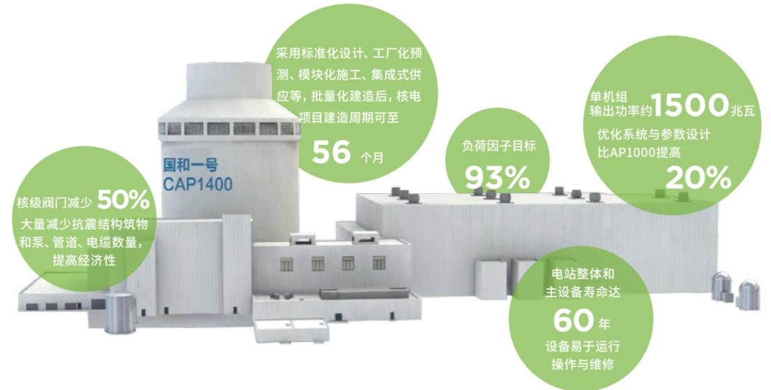
“国和一号”是上海核工院落实我国三代核电自主化发展战略，依托工程项目平台实践和国家大型先进压水堆核电站重大专项开发的、具有完全自主知识产权的大型先进非能动压水堆核电型号，是自主设计的中国核电技术品牌，其代表着当今世界三代核电技术的先进水平，是我国核电技术研发和产业创新的最新成果。
